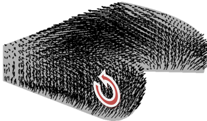
Figure .4. 14. Mouvements de tumble
