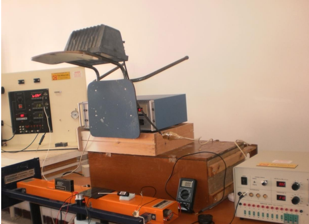
Fig.IV. 15: Position de projecteur pour I=300\text{W/m}^2 .
