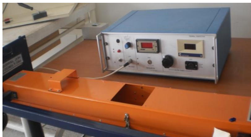
Fig.III. 4 : Unité de transfert thermique convective.
