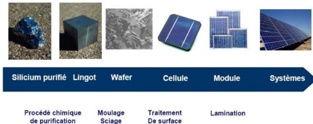
Fig.II. 12 : Différent processus appliqué sur le silicium
