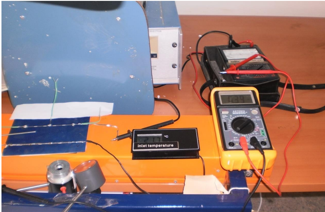
Fig. IV. 9 : Montage électrique réalisé dont le multimètre de couleur noir est utilisé comme une charge.
