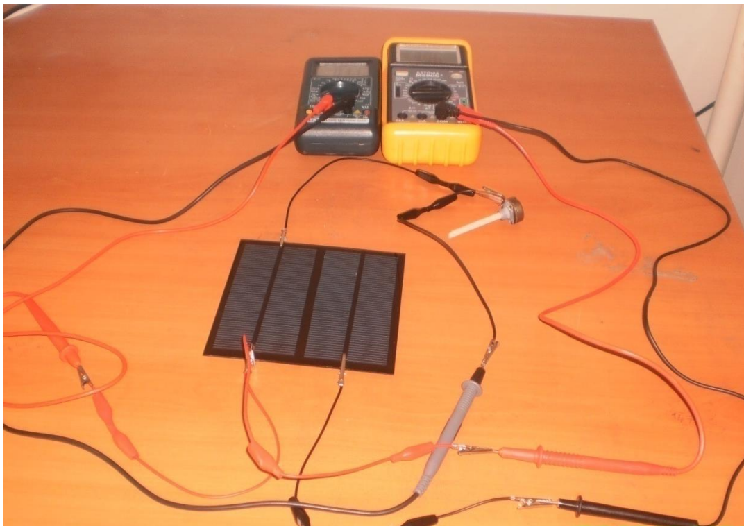
Fig. IV. 10 : Montage électrique réalisé dont le potentiomètre est la charge électrique.
