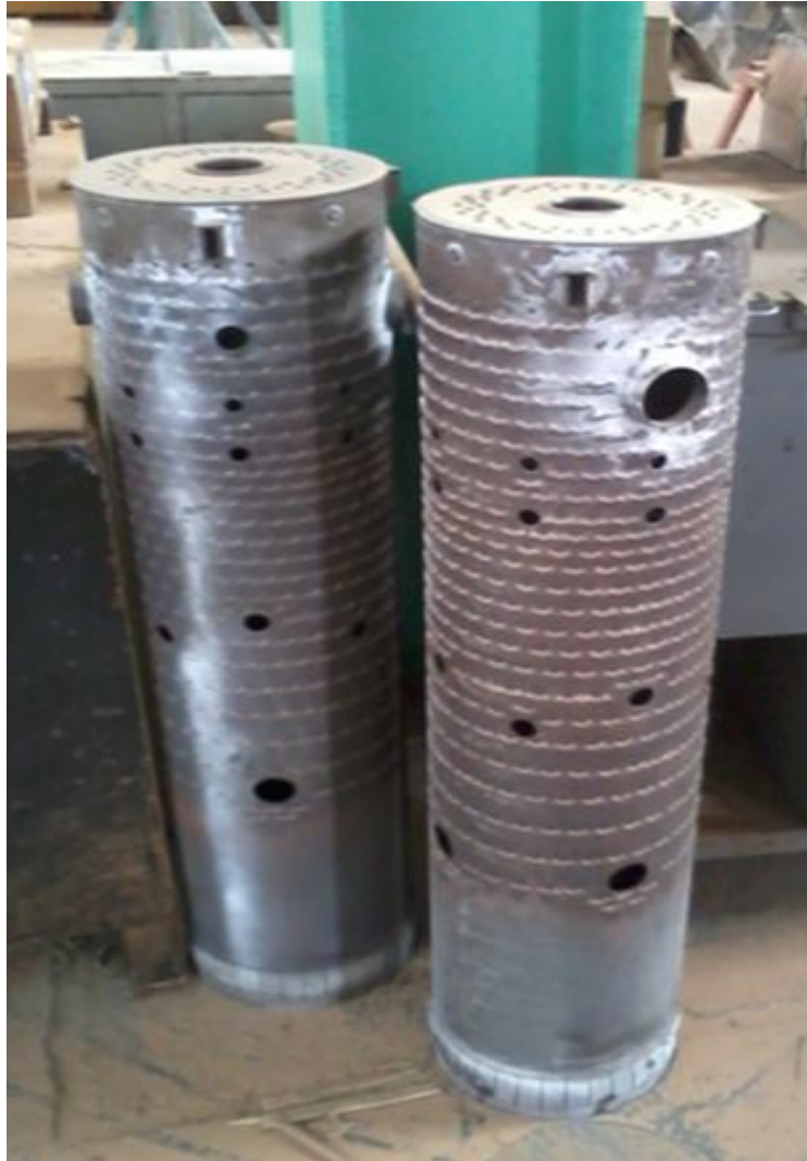
Figure III.3: photographie du Chemise de combustion
