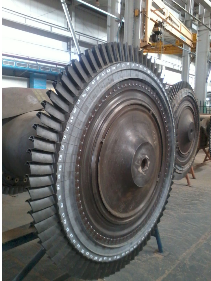
Figure III.7: photographie du Rotor de la turbine HP
