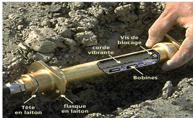
Figure II.16 : Extensomètre à corde vibrante (EDF et Cemagref 1998)
