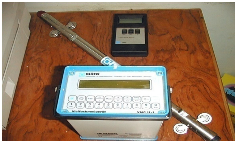
Figure II.15 : Appareil de lectures brutes inclinométriques (Smail, 2007).
