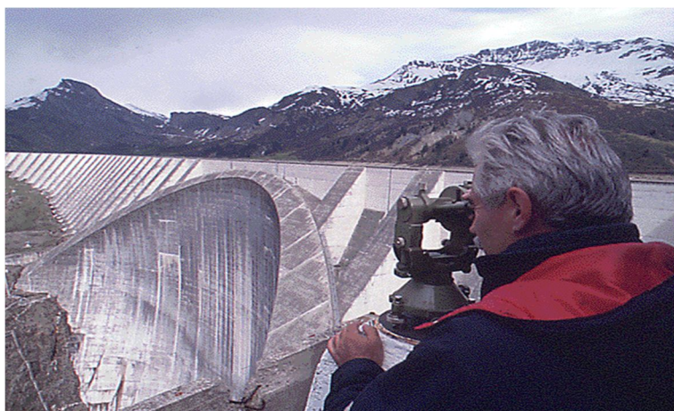
Figure II.4 : Visée de bornes d'observations pour mesure des déplacements (EDF et Cemagref, 1998)
