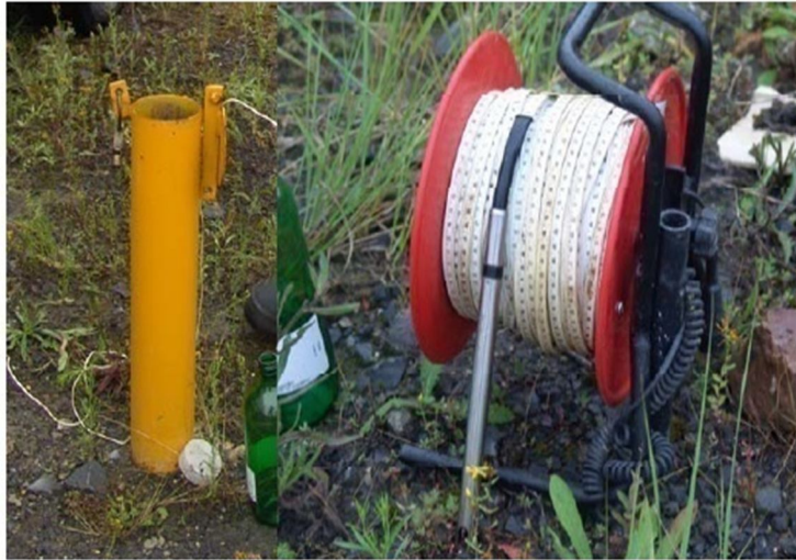
Figure II.25 : Piézomètre et sonde à interface (Vidal, 2010)
