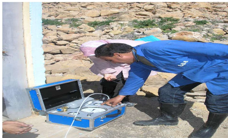
Figure II.27 : Mesure de la pression interstitielle au niveau d'une cellule pneumatique (Smail, 2007).
