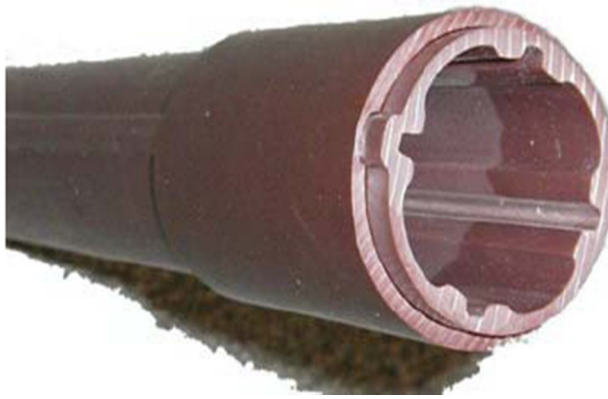
Figure II.14 : Tube inclinométrique avec rainures de guidage (Smail, 2007)
