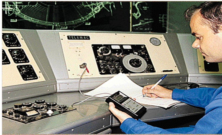
Figure II.18 : Dépouillement des mesures de l'extensomètre à corde vibrante
