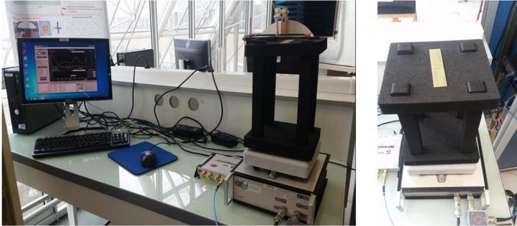
Figure IV.19 : Mesure de la distance de lecture à l'aide d'un tagformance (Unité de mesure RFID).
