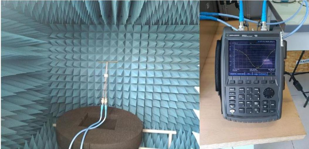
Figure IV.17 : Mesure d'impédance des antennes dans la chambre anéchoïque de VERNON à l'aide d'un VNA.
