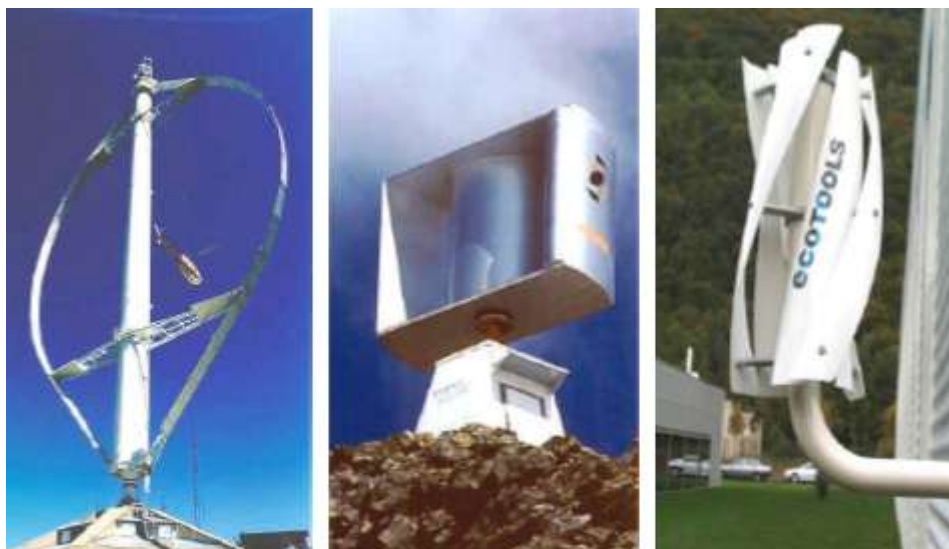
Figure I. 16 : Eoliennes à axe verticale.[12]
