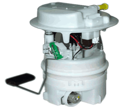
Figure1.21 : Pompe et régulateur immergés.[11]
