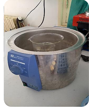
Figure 10. Bain d'eau contenant les tubes de miel (Photo prise par Mlle Lakermi H.)
