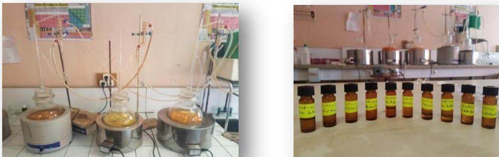
**Figure 22.** Montage d'hydrodistillation type Clevenger.
