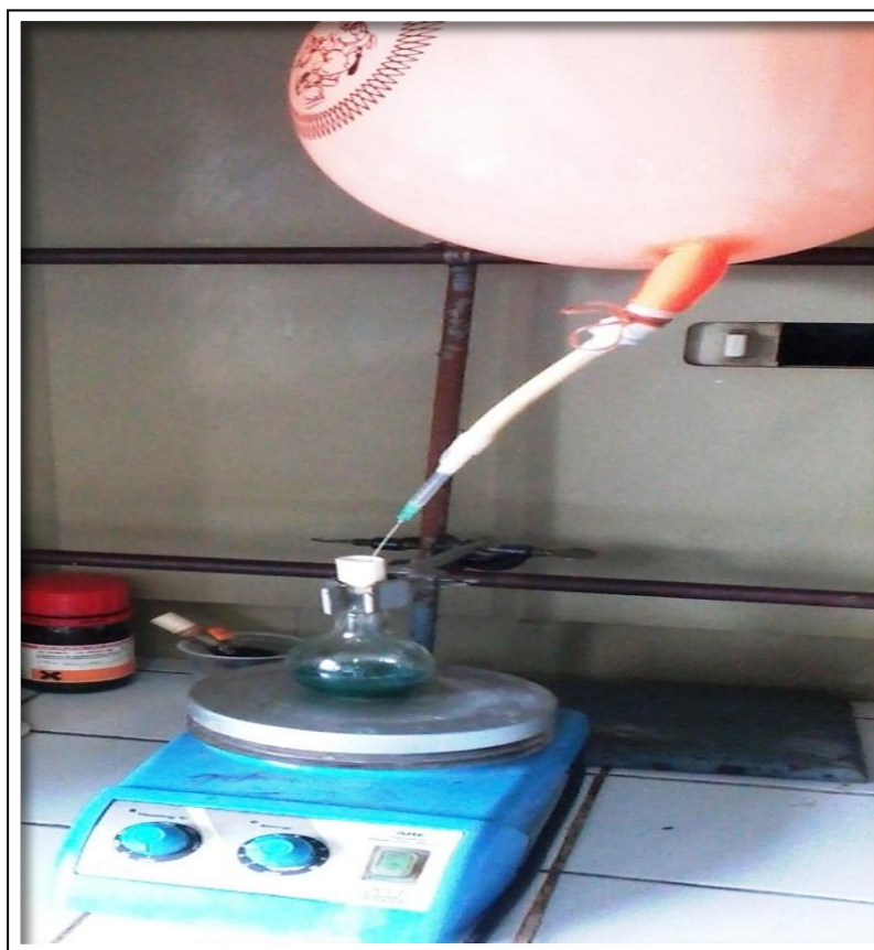
Figure II.2: Montage de la polymérisation radicalaire contrôlée.
