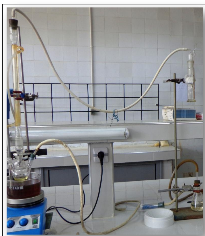
Figure II.3: Montage de la polymérisation cationique.
