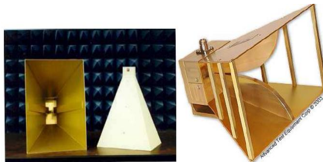
Figure I-21. À gauche : antenne cornet classique À droite : cornet ridgé [20]
