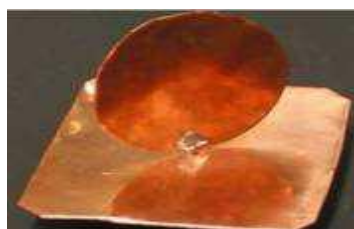
Figure I-17. Exemple de réalisation pratique d'un monopole circulaire [7]
