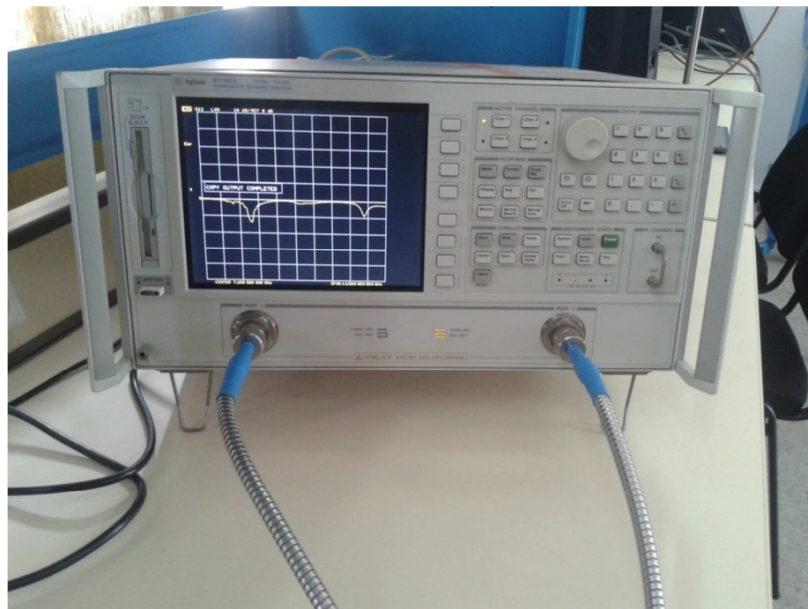
Figure C.1 Analyseur de réseau
