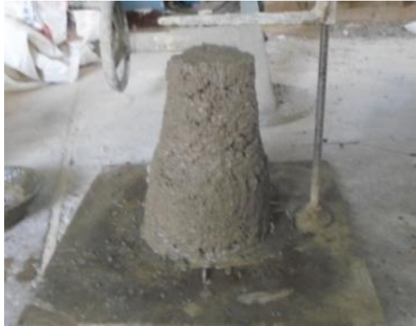
Figure 3.21. Etalement du béton utilisé pour fabriquer les dalletes.
