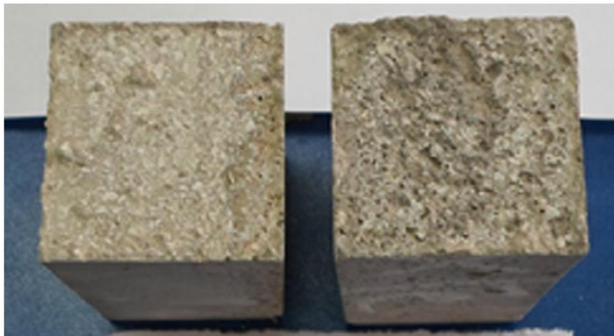
Figure 4.23. Mode de rupture des éprouvettes bicomposées.
