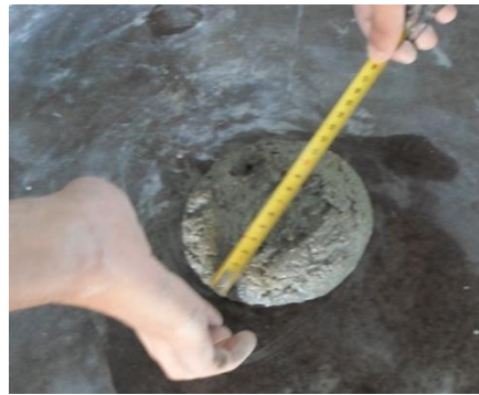
Étape 3. Mesure des deux diamètres perpendiculaires de la galette obtenue.
