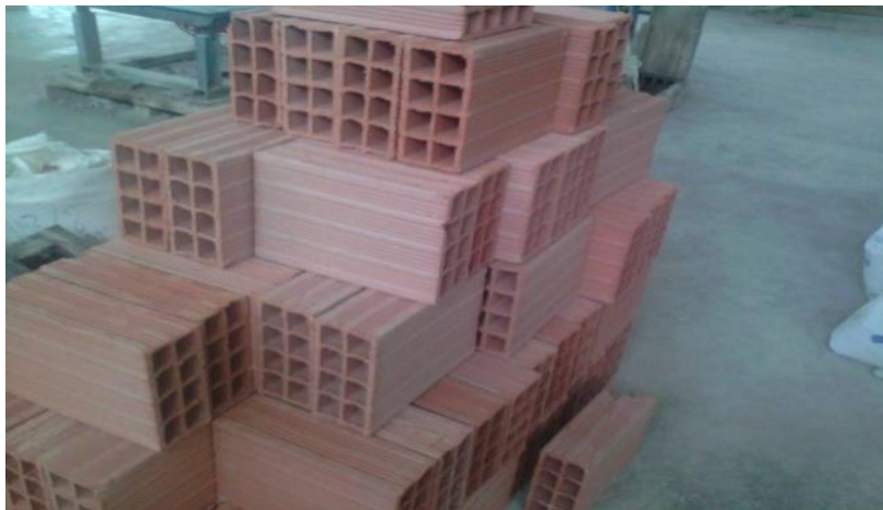
Figure 3.19. Supports en briques utilisés.
