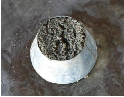
Étape 1. Placement du mortier dans le moule tronconique.
