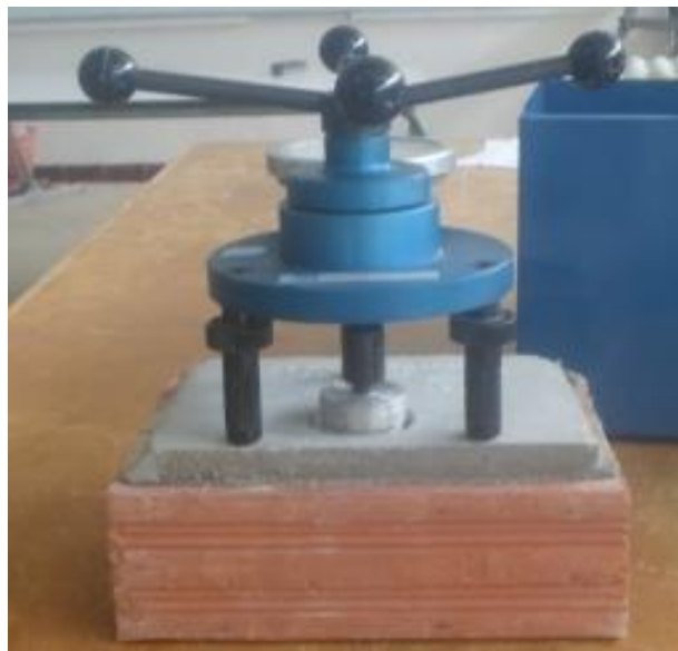
Figure 3.29. Déroulement de l'essai d'arrachement.
