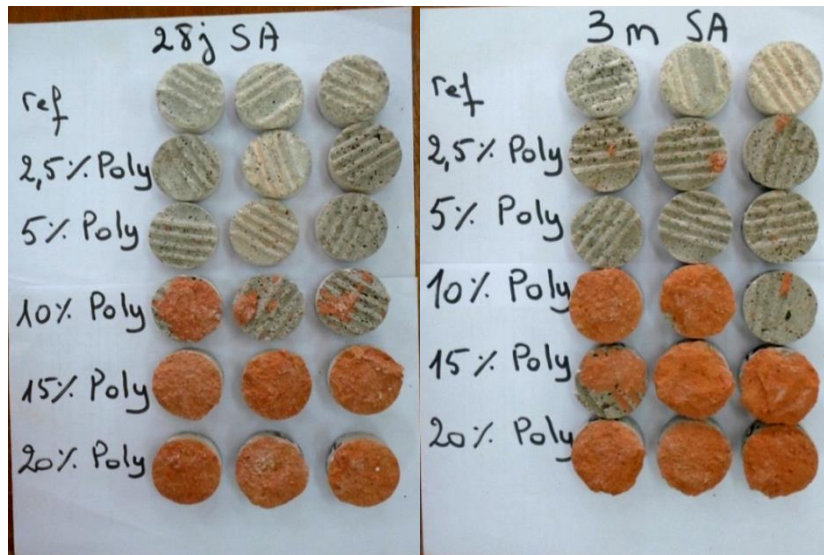
(b) Modes de rupture des mortiers modifiés SA– brique à l'âge de 28 et 90 jours
