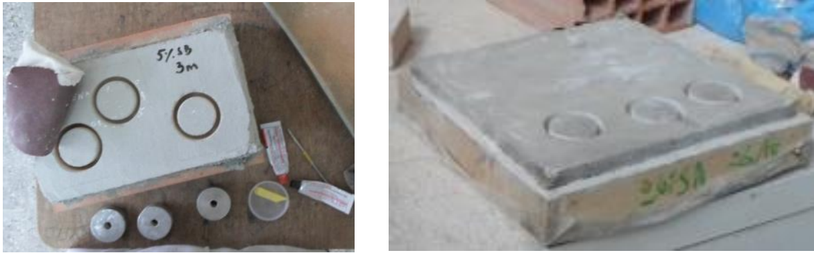
Figure 3.27. Enduit carotté sur les deux supports en briques creuse et en béton.
