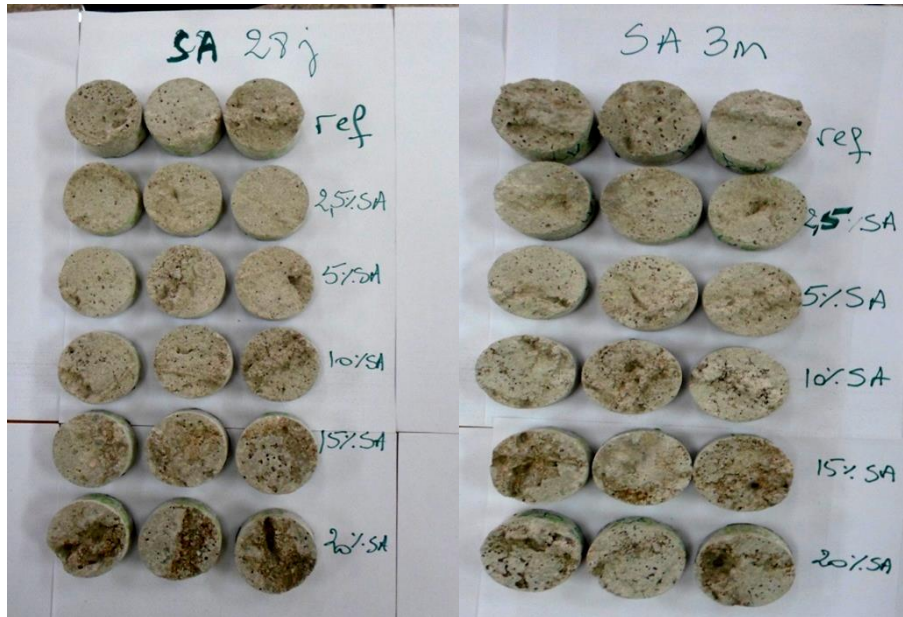
(b) Modes de rupture des mortiers modifiée SA-dalletes en béton à l'âge de 28 et 90 jours
