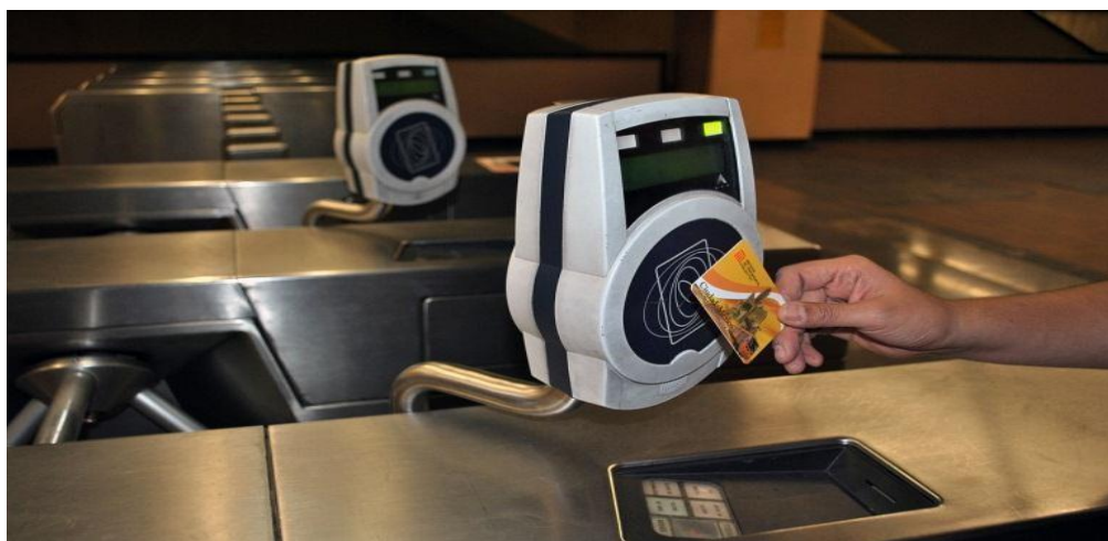
Fig.I 14 : Portillon RFID dans une station de métro.
