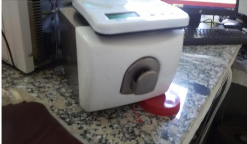
Figure 29 : Clampeuse-soudeuse électrique BAXTER®
