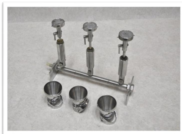
Figure 21 : Rampe de filtration
