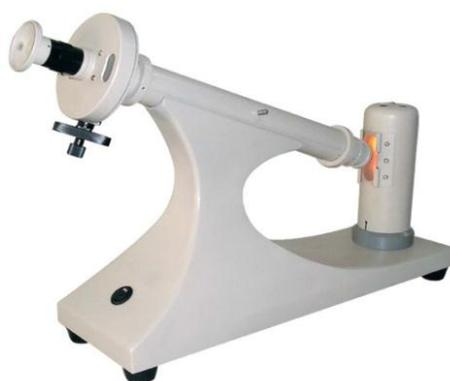
Figure 14 : Polarimètre
