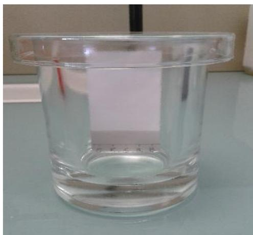
Figure 13 : Réalisation d'une CCM
