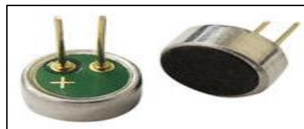
Figure III.11: Microphone à électret réel
