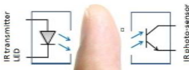
Figure 2 12: Configuration du capteur utilisé pour la détection du signal PPG
