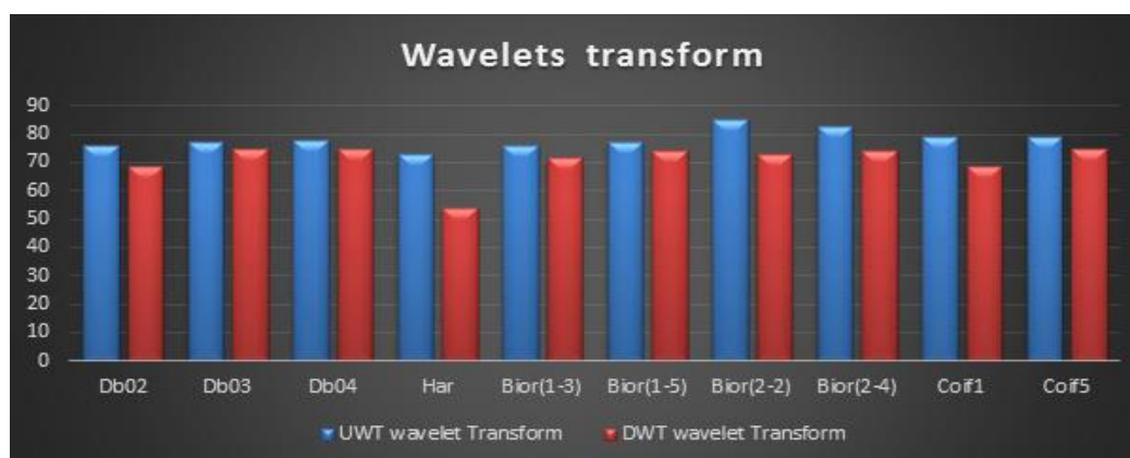
Figure 3 10: Histogrammes illustrant les rapports SNR obtenus avec différentes ondelettes mères pour chacune des transformées UWT et DWT appliquées pour le filtrage du signal PPG.
