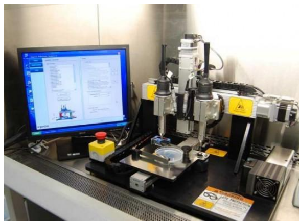
Figure 37 : L'imprimante Novogen MMX, capable de bio imprimer des cellules et tissus humains.
