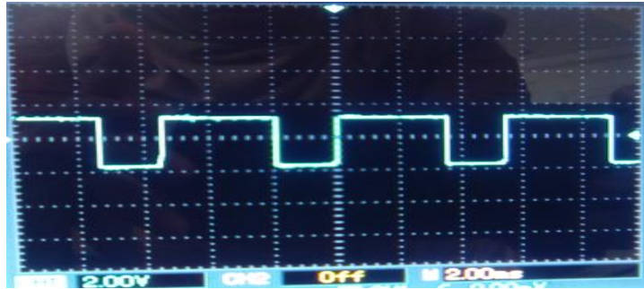
Figure 66: le signal de sortie du circuit comparateur
