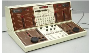
Figure 37: Audiomètre clinique bi-canal Beltone circa 1970, dominé par des boutons poussoirs.
