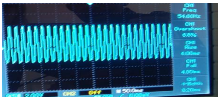
Figure 65: le signal d'entrée du circuit comparateur.
