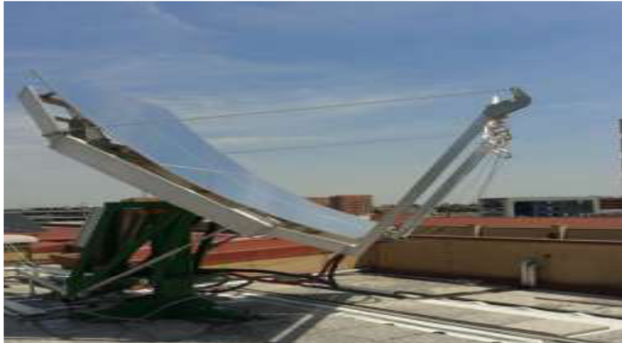
Fig. 2.23. Prototype CPVT lors des essais à l'Université de Padoue [58].
