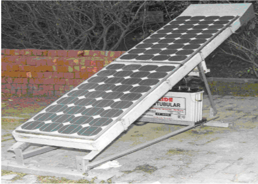
Fig. 2.9. Photographie de l'installation expérimentale d'un collecteur d'air hybride PV / T [44].
