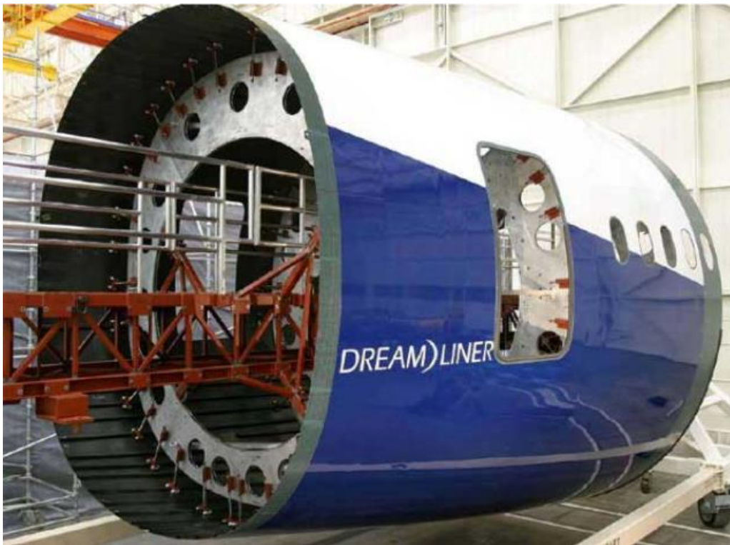
Figure 2.16 : Fabrication de grande section de fuselage du Boeing 787 Dreamliner par AFP (Ijsselmuiden 2011).
