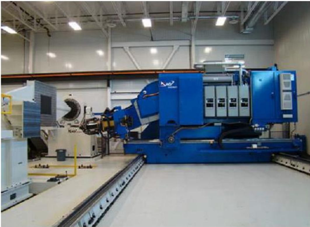
Figure 2.14 : Machine de placement automatisé des fibres (AFP).
