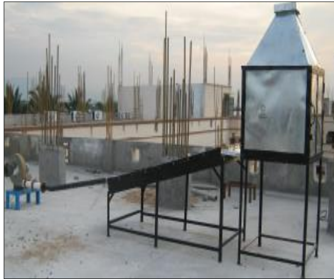
Figure I. 9: La configuration expérimentale du séchoir solaire
