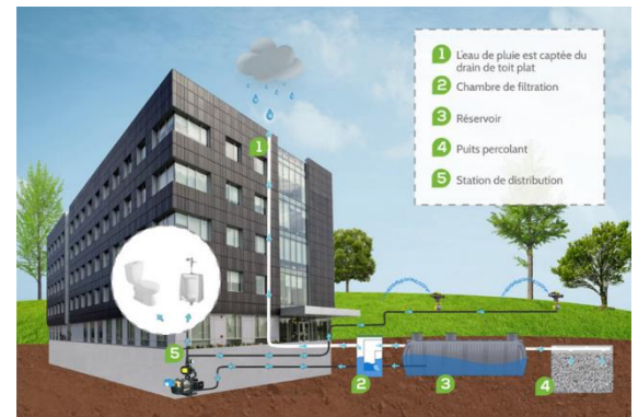
Figure 158: recyclage des eaux pluviales
