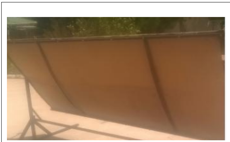
Fig3.8.Vue par arrière du réflecteur
