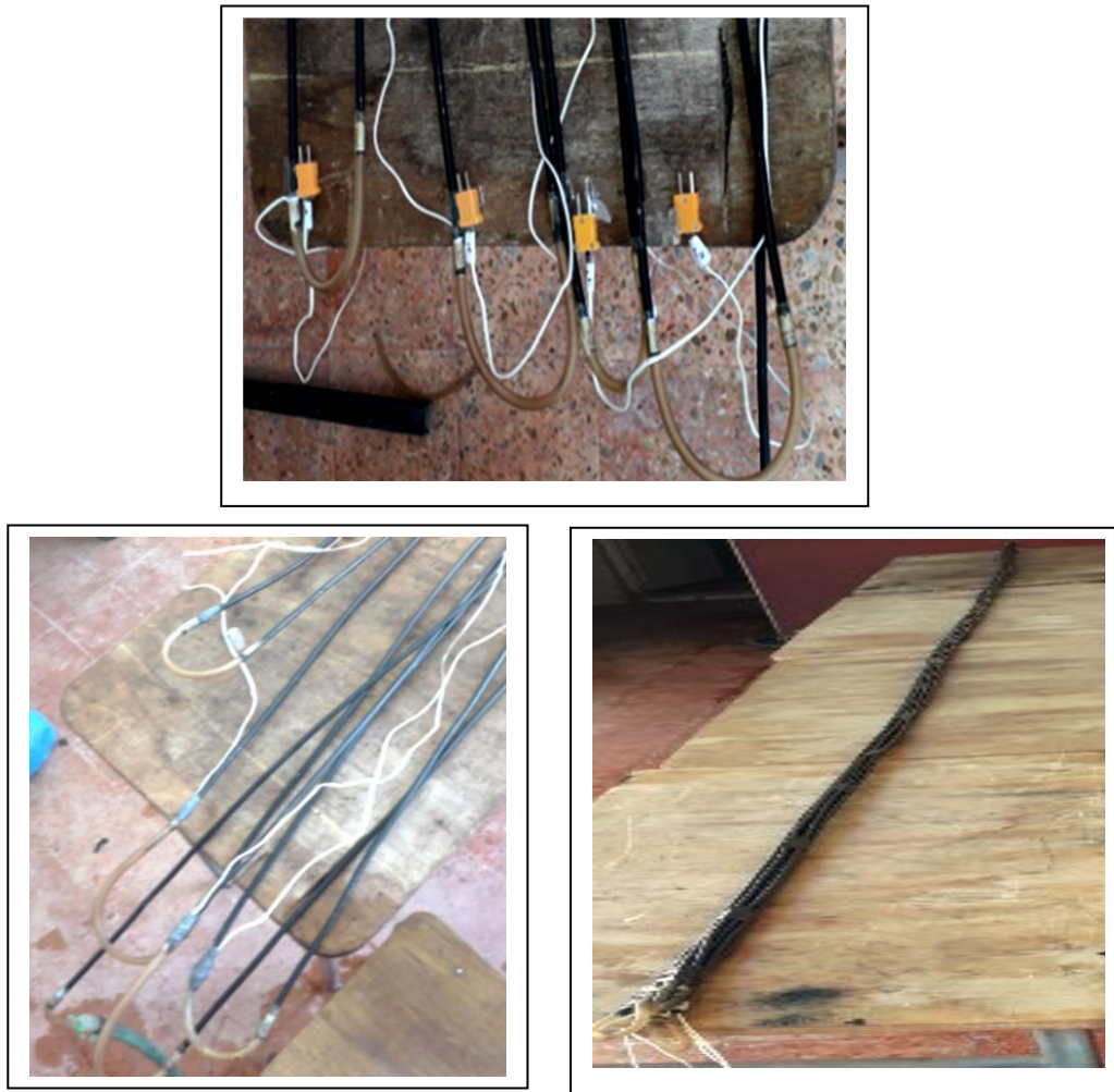
Fig.3.4 : Le tube absorbeur, emplacement des thermocouples et assemblage des tubes
