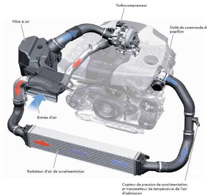
Figure I.21 Le système de refroidissement de l'air de suralimentation Pour un moteur V6 TDI [16].
