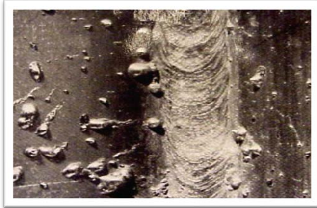
Figure 30 : projections sur le métal de base[2]
