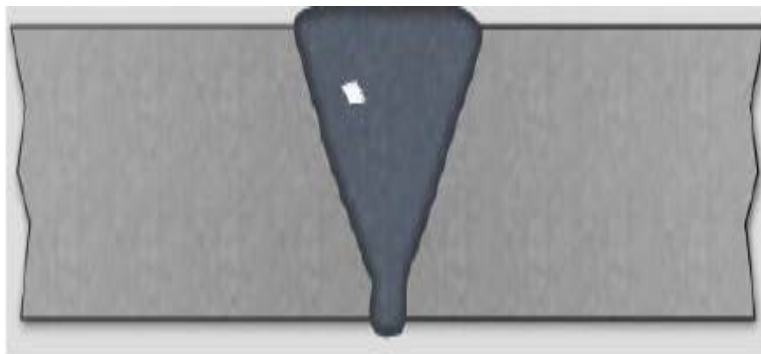
Figure 20c : inclusions de cuivre[2]
