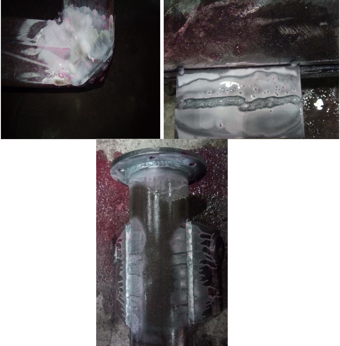
Figure V-19 : application du révélateur.
