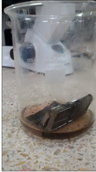
Figure IV-7 : attaque chimique au Nital.
