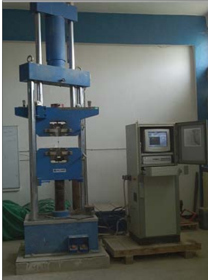
Figure IV-4: Machine 600 KN pour d'essai de traction.
