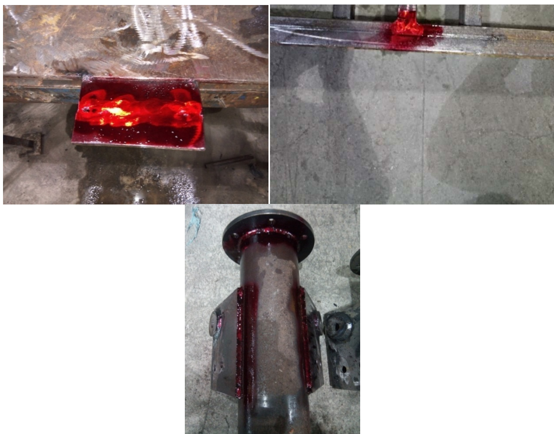
Figure V-18 : application du pénétrant.
