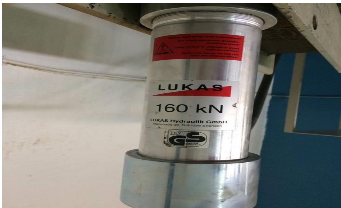
Figure III.2 : Vérin double effet de 160 KN couplé avec le banc d'essai
