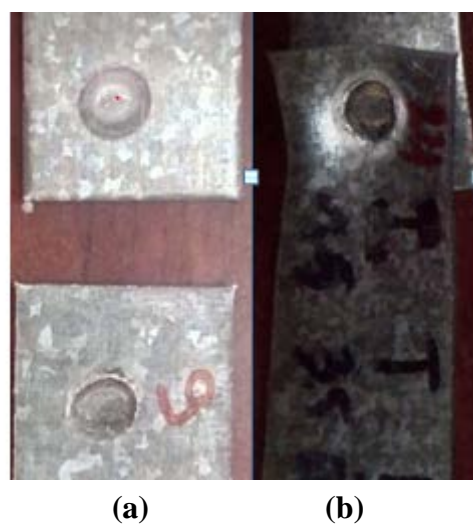
Figure III.1 : les mode de (a) par rupture du noyau fondu du point soudé dans sa section droite minimale, (b) rupture par déboutonnage.
