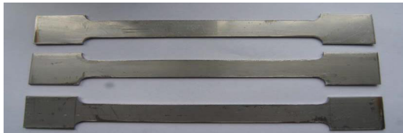
Figure 3.3 : éprouvette pour l'essai de traction en 304 L.
