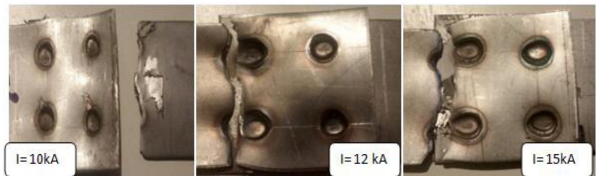
Figure 4-18 : la rupture finale l'éprouvette de type C
