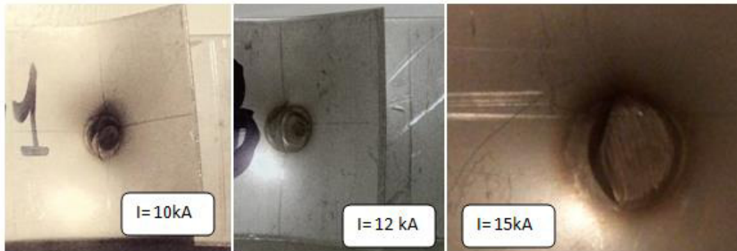
Figure 4-20 : la rupture finale l'éprouvette de type (D)
