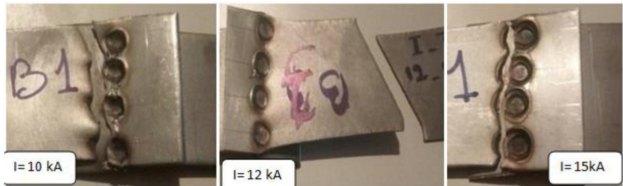
Figure 4-16 : la rupture finale l'éprouvette de type (B)
