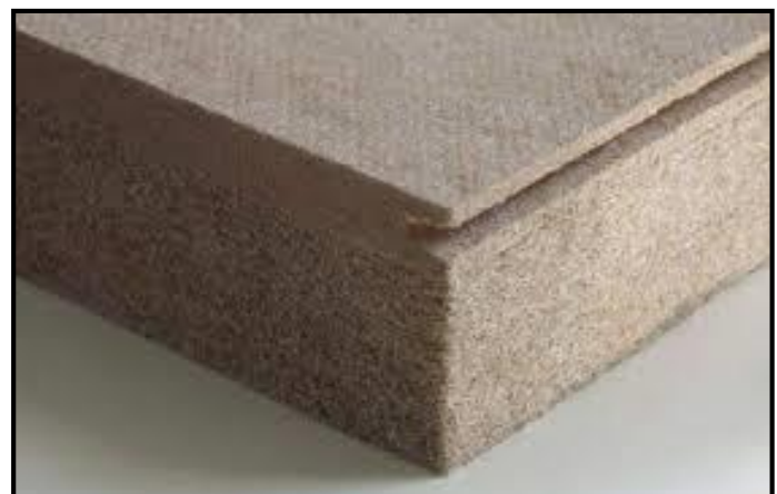
figure 154: la fibre de bois comme matériaux isolant
