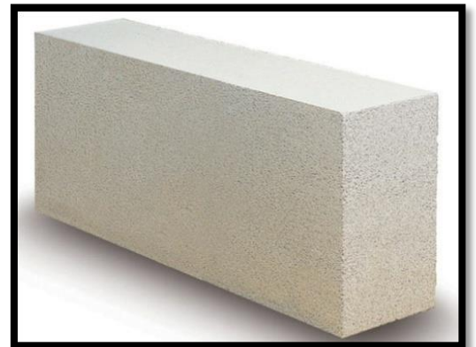
figure 147: brique fabriqué par un BFUHP
