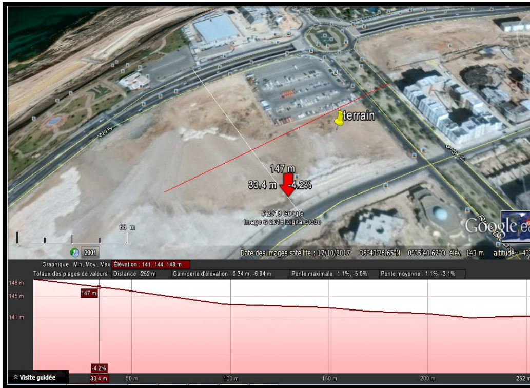
figure 122: La coupe 2 longitudinale : (d'après le profil d'élévation) la pente moyenne varie entre 1.1% et -3.1%
