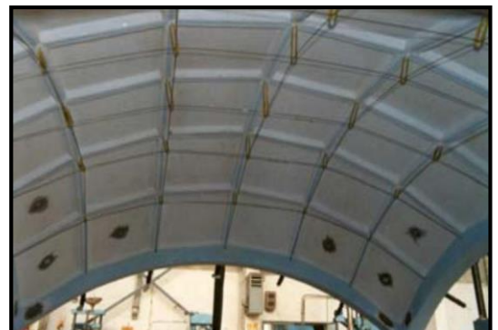
figure 139: Coque elliptique précontrainte par l'intérieur.
