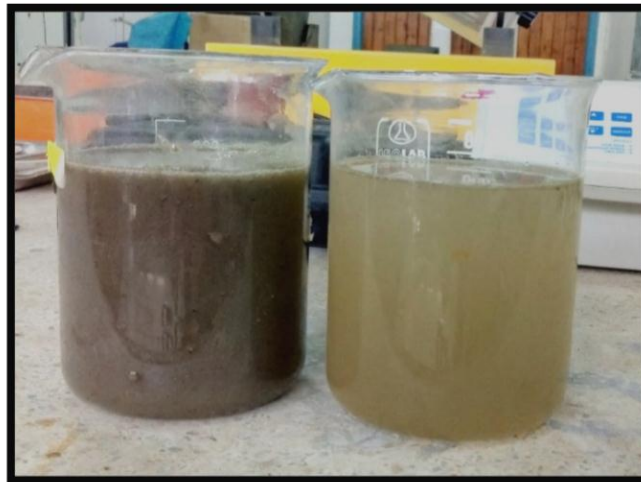
Figure III.28 : Eau à l'entrée et la sortie du décanteur lamellaire à contre-courant « Position B »
