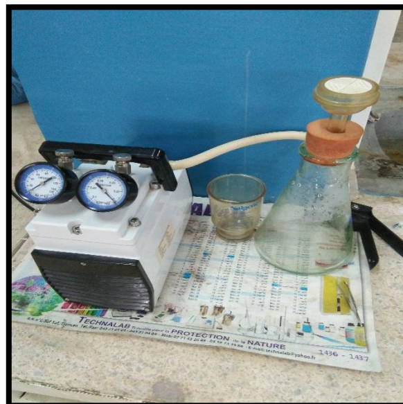
Figure III.5 : Dispositif de filtration.
