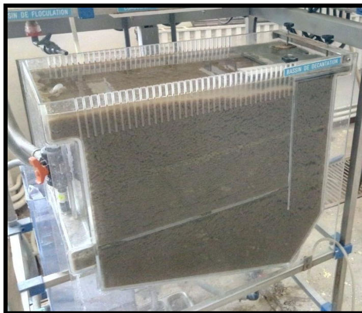
Figure III.44 : Colmatage du décanteur (Décantation classique).
