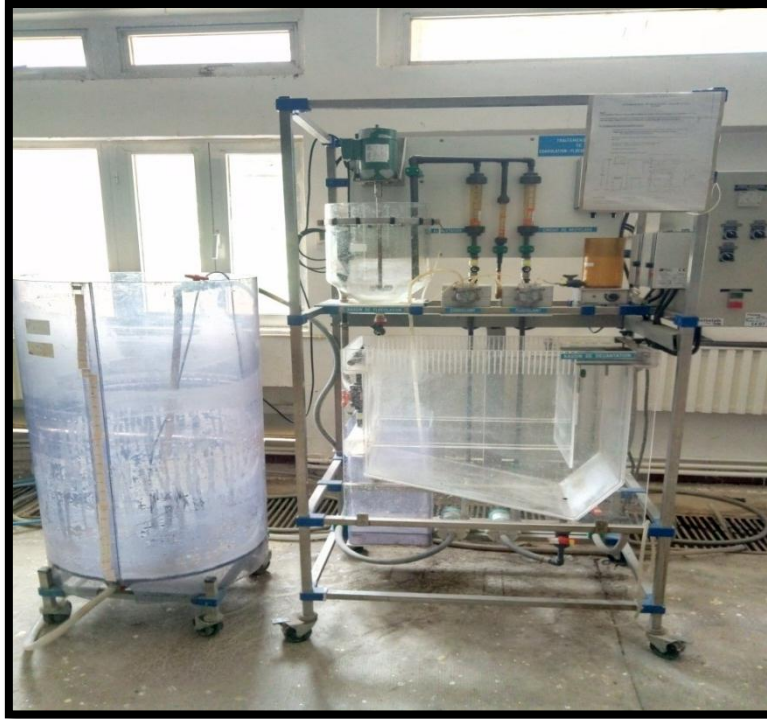
Figure III.2 : Pilote de coagulation-floculation et décantation (TE-600) (laboratoire du Département d'Hydraulique. Université de Tlemcen).
