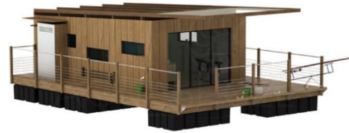
Figure 195 : construction sur flotteurs
