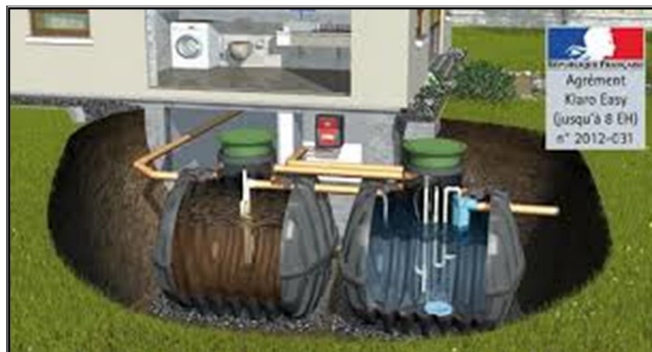
Figure.83. exemple d'une micro station d'épuration
