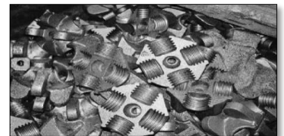
Figure 24: Nœuds sphérique creux NODUS
