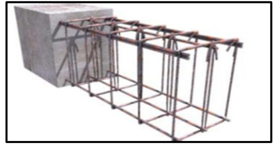
Figure 142: poteau en béton armé
