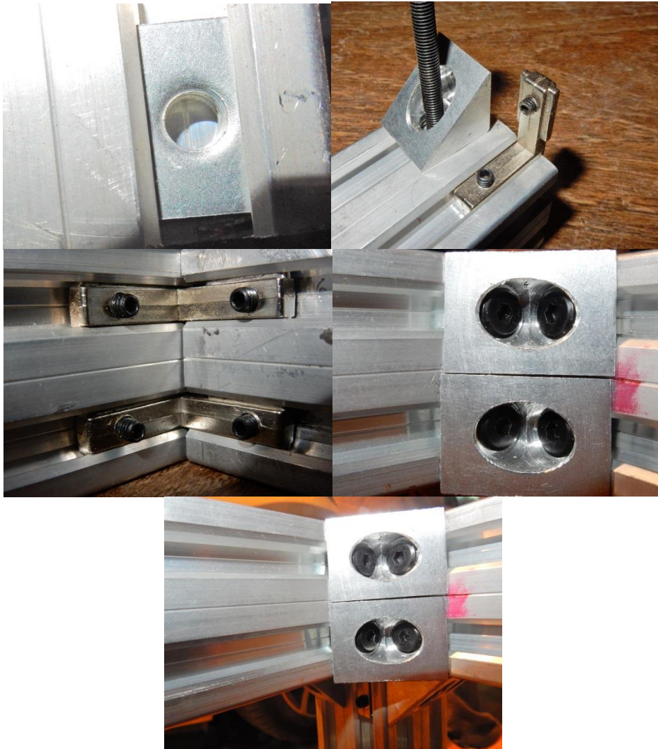
Figure V.1 : Assemblage du portique
