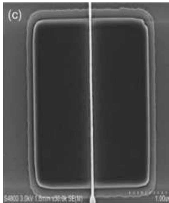
Figure 2.18 – Croissance épitaxiale réussie d'un film de SiGe, d'une bonne qualité. [Liu, 2017]
