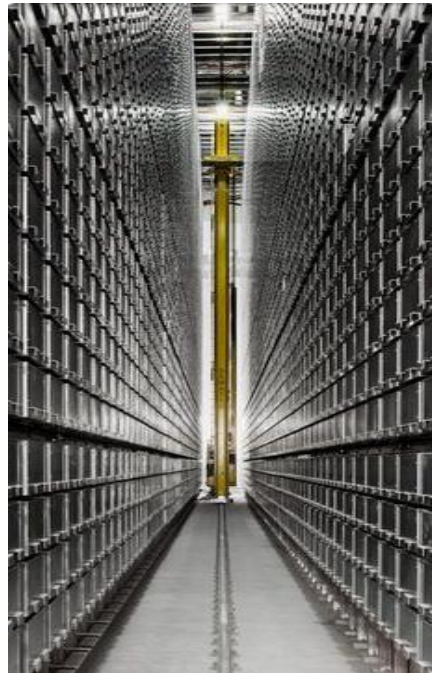
Figure 1. 5 une machine de stockage/déstockage.
