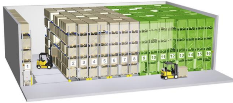
Figure 1. 10 : AS/RS à rack glissant
