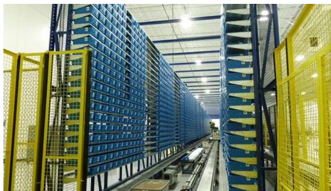
Figure 1. 11 : AS/RS à mini charge ou à charge réduite
