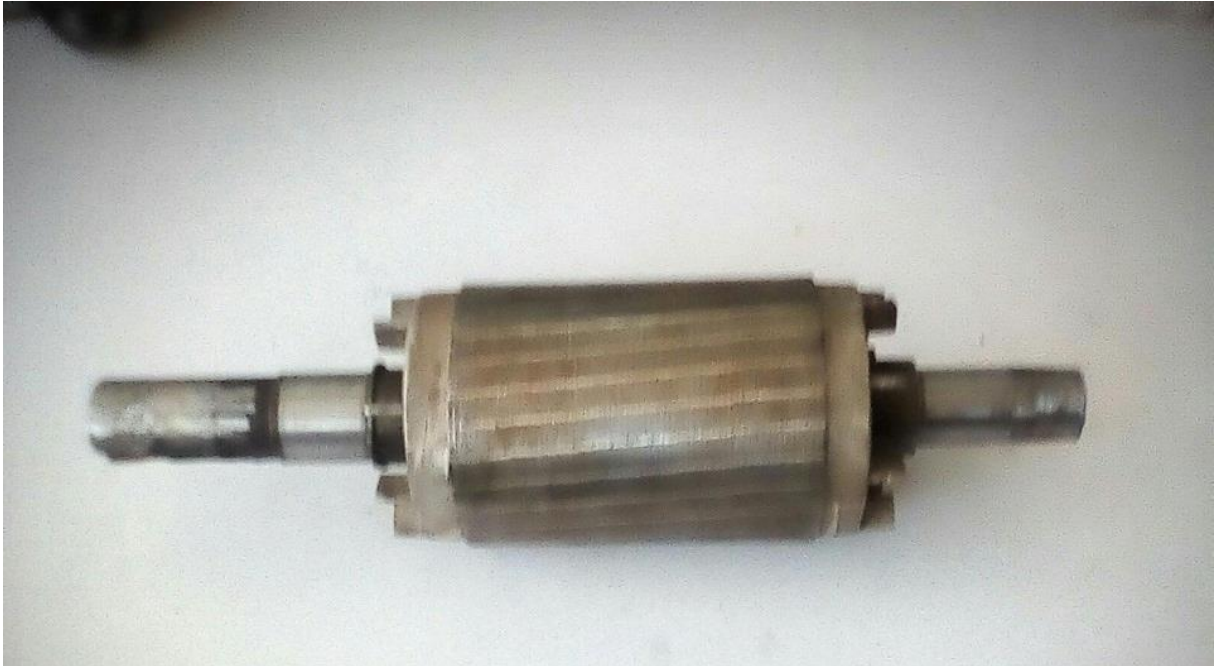
Figure 4. 5: Le rotor magnétique.
