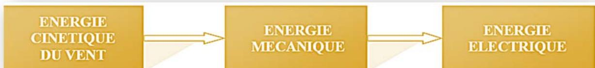
*Figure 1.1 : Conversion de l'énergie cinétique du vent*
