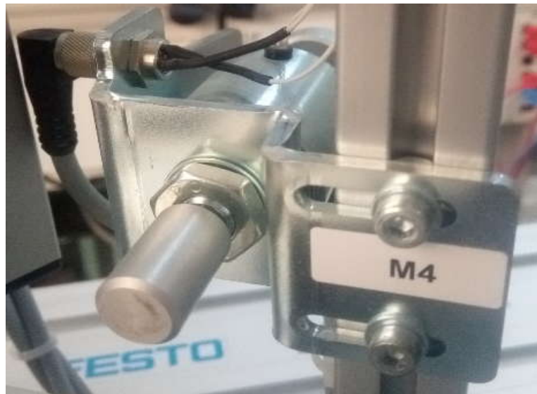
Fig. III.12: module de serrage (L'électro-aimant de fixation).
