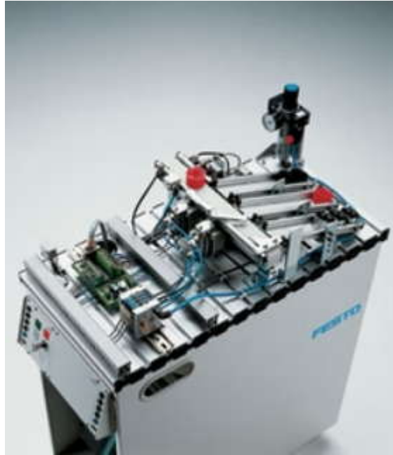
Fig. II.10: Station de livraison
