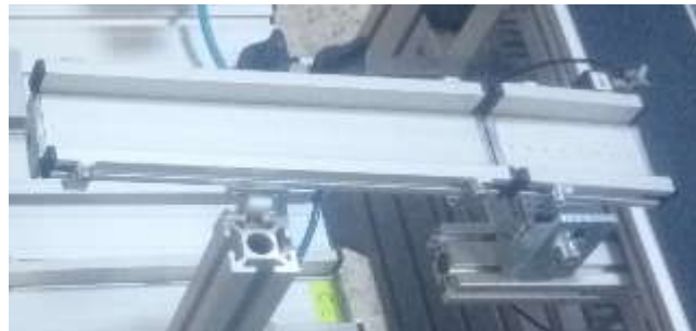
Fig. III.25: Le module de glissement.
