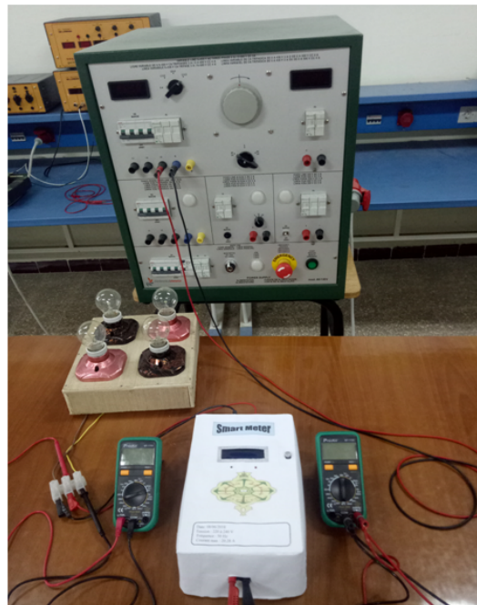
FIGURE III.8 – Schéma de connexion de la charge résistive lors du test.
