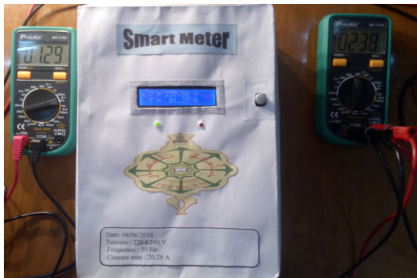
FIGURE III.10 – Observation des données de consommation d’une charge résistive.
