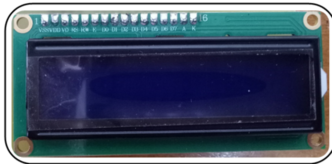
FIGURE II.24 – Afficheur LCD alphanumérique 2 \times 16 .
