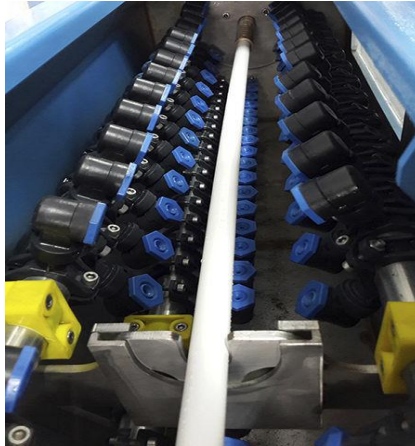
Figure 33. Bac de refroidissement
