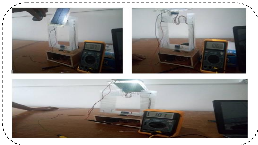
Figure IV.16 les valeurs de tension d'un système suiveur
