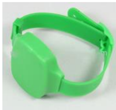
Figure 2. 23 Une étiquette active
