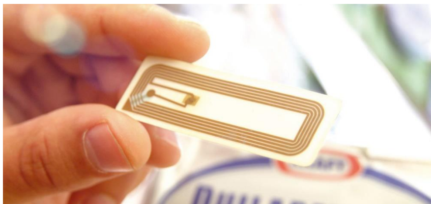
Figure 2. 21 Une étiquette passive [22]
