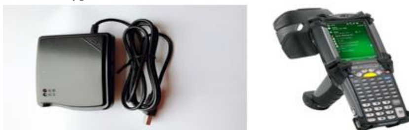
Figure 2. 20 Les lecteurs RFID fixe et mobile [21]
