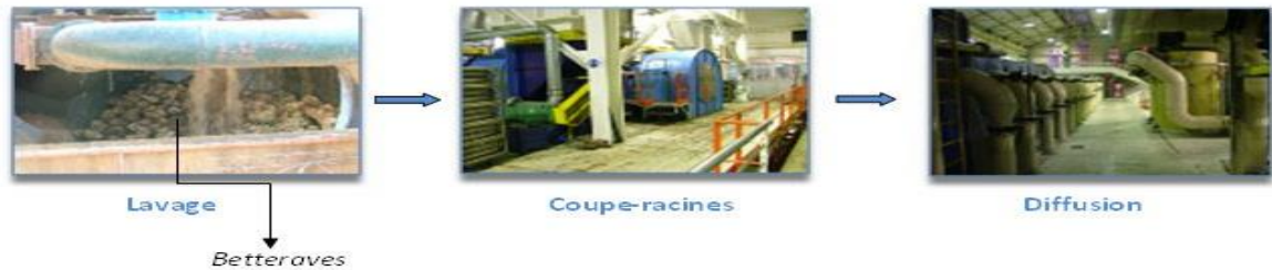
Figure II. 8: Les trois étapes de Lavage, coupe-racines et la diffusion de la betterave sucrière
