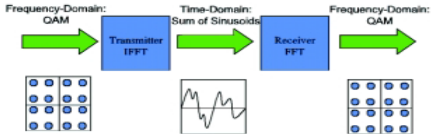
Figure 1.11: Schéma fonctionnel d'un système OFDM simple
