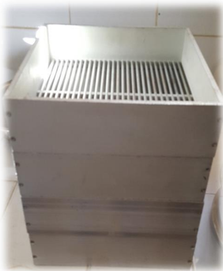
Figure 3.6. : Les tamis à mailles carrées de l'essai « forme des granulats ».
