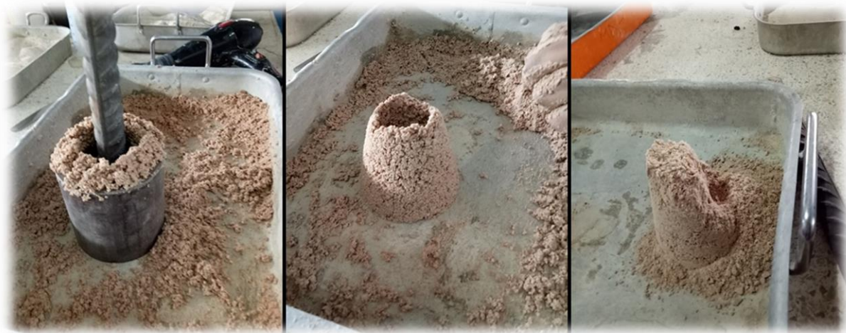
Figure 3.5. : L'essai d'absorption pour le sable.
