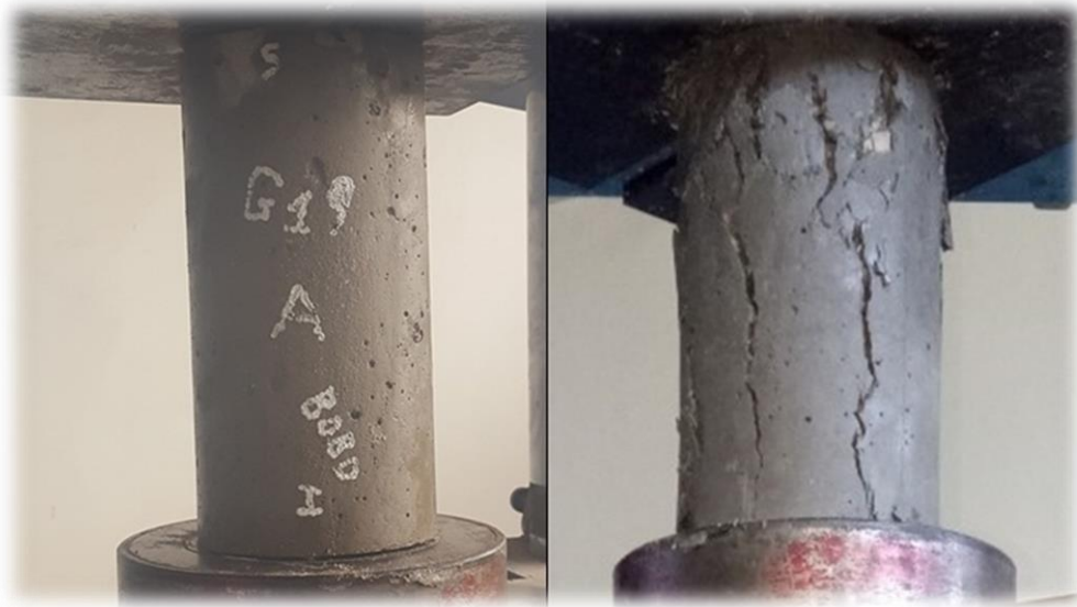
Figure 4.5. : Essai de la résistance à la compression.
