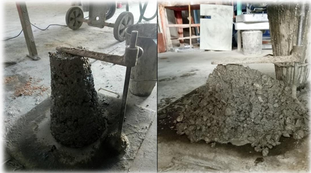
Figure 4.3. : L'affaissement au cône d'Abrams (affaissement de 10 mm et 185 mm).
