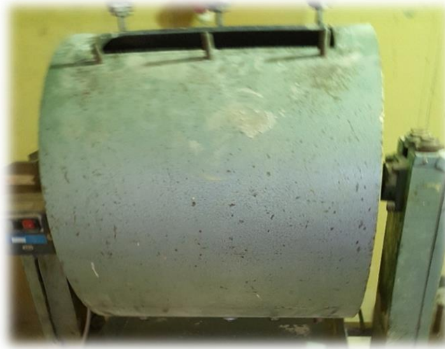
Figure 3.8. : La machine de l'essai Los Angeles.
