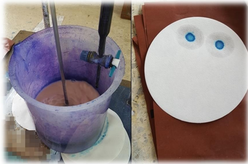
Figure 3.3. : L'essai au bleu de méthylène.
